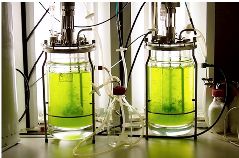
Bioreaktorer til dyrkning af mos monteret med en håndfuld sensorer til at bestemme kemiske og fysiske parametre, alle elektriske med en ledning stikkende ud fra reaktoren.
